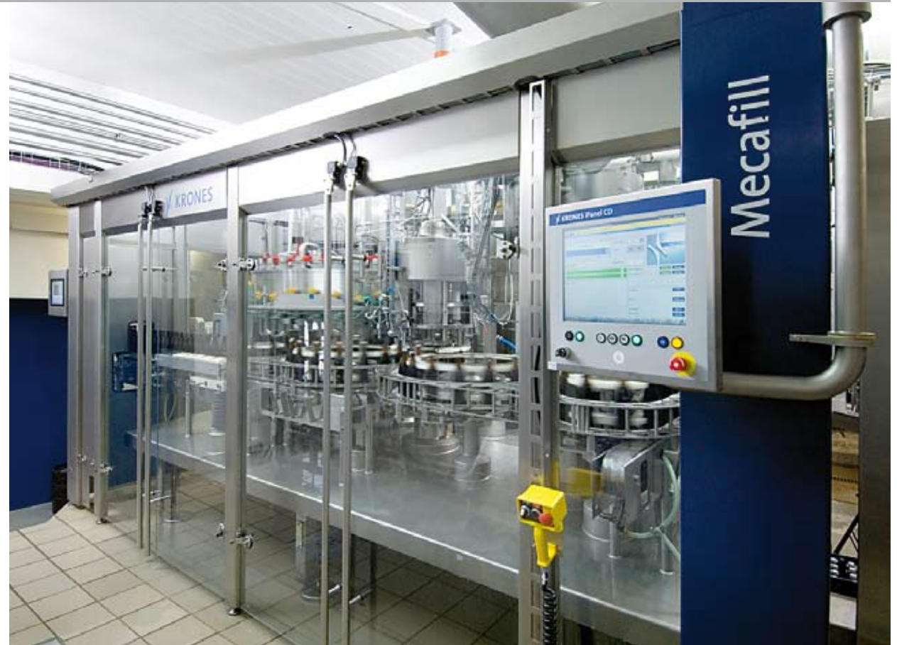
Mecafill VKP-PET en ejecución con mesa de tipo Roof-Table
