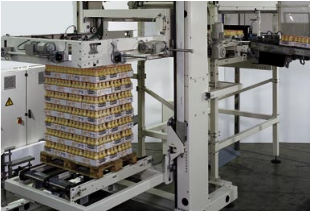
Paletizadora Pressant Universal 1A con estación de carga fija y unidad de levantamiento de palets
