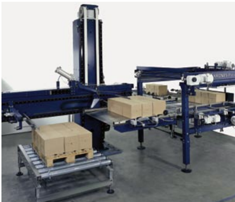
La paletizadora Pressant Compact carga bandejas en capas enteras.
