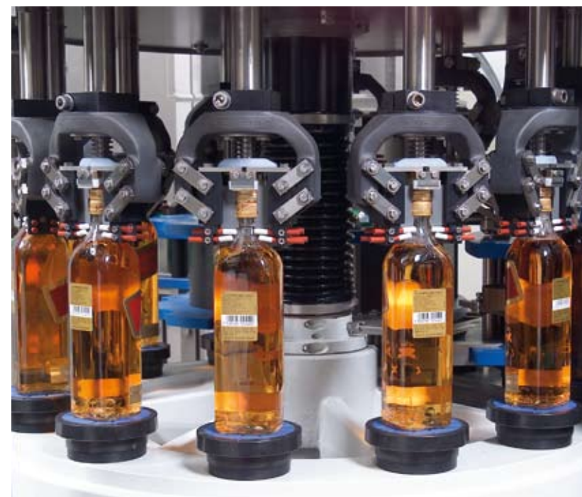
Los elementos alisadores presionan los precintos fiscales con precisión contra la botella.
